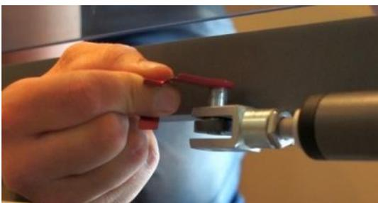
1. Ziehen Sie die Feder mit einem geeigneten Werkzeug aus der Spindelachse, einem Schraubenzieher, Lineal, Flaschenöffner o. Ä.
